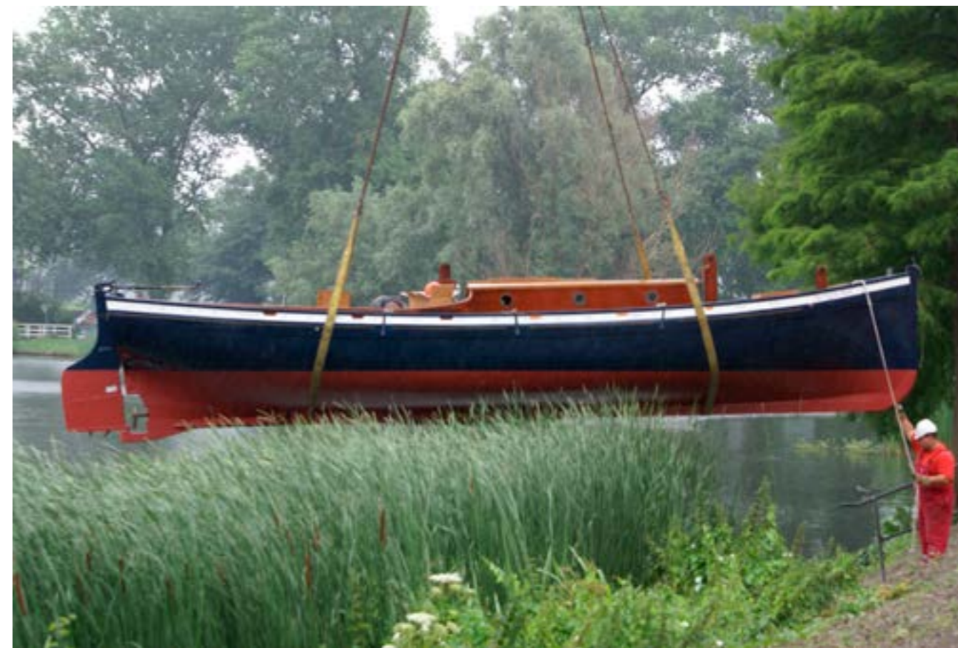
De 'Vijfde Meid' in de takels: 0.60 meter diepgang, 1.60 meter 'airdraft'
