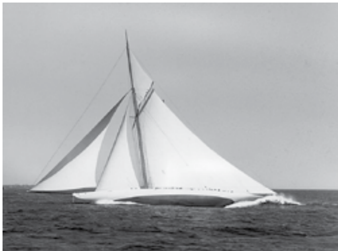
Geen regenboog, maar de Reliance, volgens de International Rule ontworpen door Herreshoff, met meer dan 1500 m2 zeil. Zie de hekgolf.
