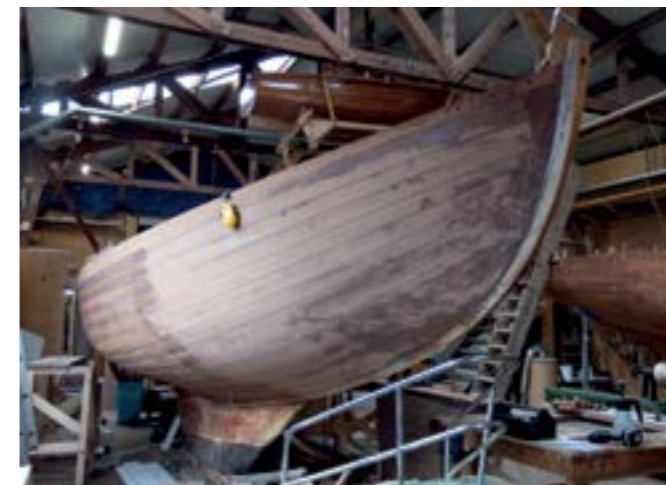
De romp van de nieuw gebouwde D-klasser.
