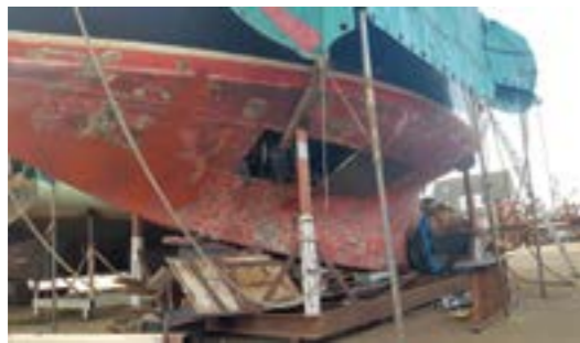
Het oude plaatwerk verwijderd.
