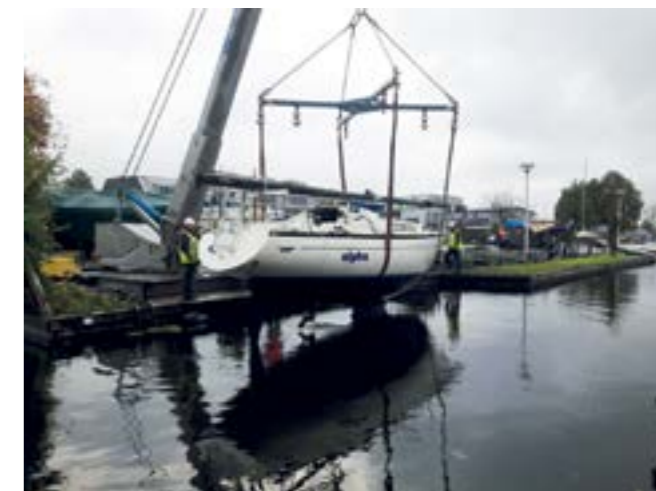
De Alpha in een kraan met spreikruis. Hier is na aftrek hijsmateriaal, tankinhoud e.d. gewichtsbepaling mogelijk.
