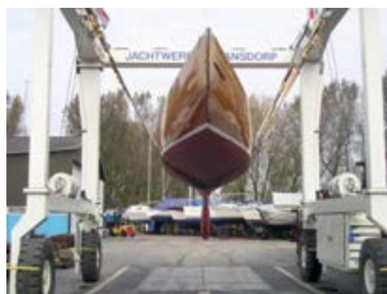
De Gazell in de takels in een portaalkraan. Gewichtsbepaling is slechts mogelijk na toepassing van een correctie.
