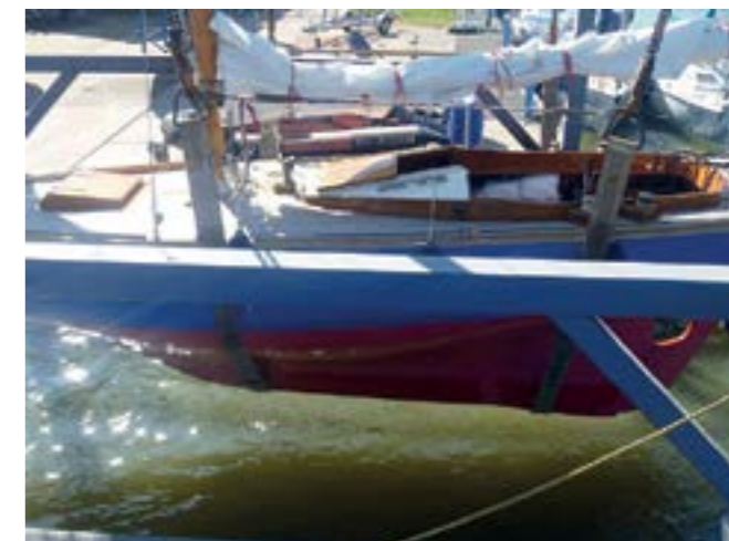
De Bluebird in een portaalkraan. Hie smaller het schip, hoe groter de hoek die de hijsingels kunnen maken.
