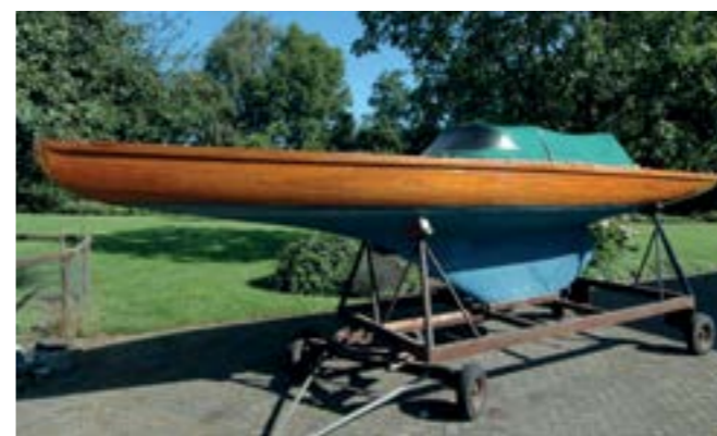
S-spantromp, lange overhangen en lepelboeg.
