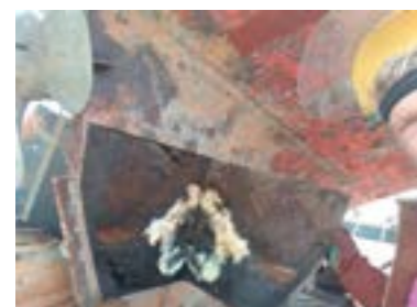
Verrassingen die tevoorschijn kwamen bij het strippen van het onderwaterschip.
