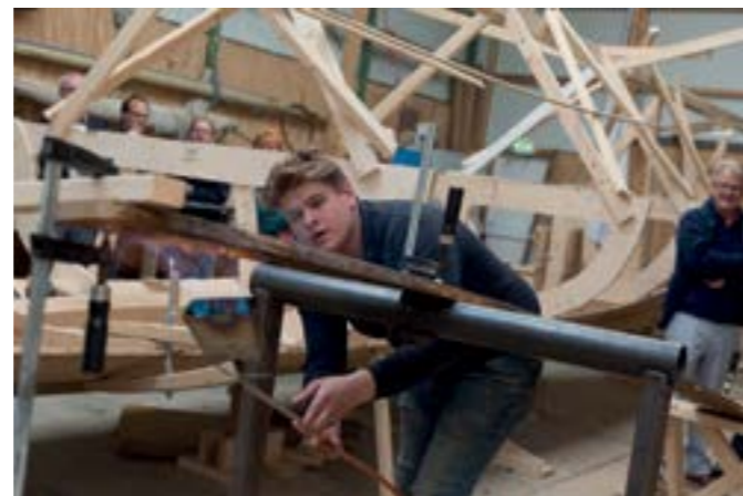
Leerlingen van het Regionaal Opleidings Centrum aan het werk aan het vikingschip: de mallen zijn geplaatst, er wordt een huidgang gebrand (foto Marieke Balk).
