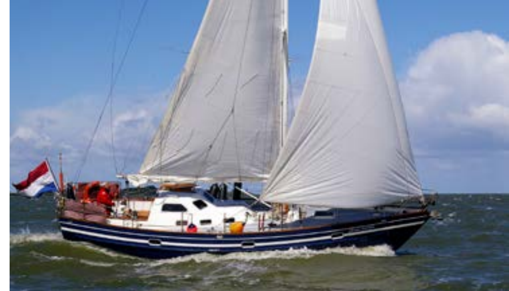
Carena 36 Shamal: cockpit en kajuit één spant naar voren geplaatst, zetboorden in plaats van voetlijsten en in staal uitgevoerde buiskap naar voorbeeld Carlot-klasse reddingboten
