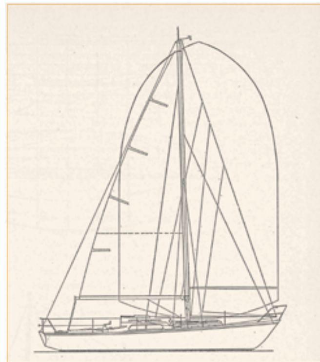
Zeilplan Carena 32 (uit ir. J. Loeff, De Zeilsport, 1968)
