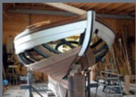
Het einde van de restauratie komt in zicht. Het interieur van de Narwal is weggenomen, maar kan straks weer worden teruggeplaatst.
