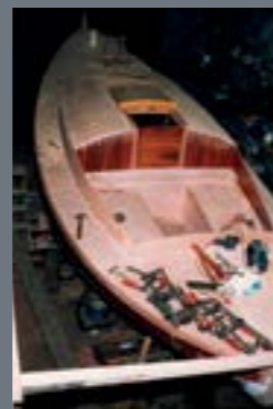
Een nieuw dek en een nieuwe kuip op de Narwal.
