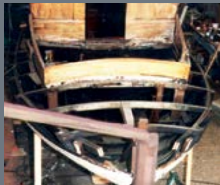
Na enkele jaren bleek de Narwal aan groot onderhoud toe te zijn. Dat werd in 1994 in Workum uitgevoerd door Johan Prins en Bartel Porsius. Stevens, dek, opbouw en de bovenste gangen werden vernieuwd. Hier is het achterdek weggesloopt.
