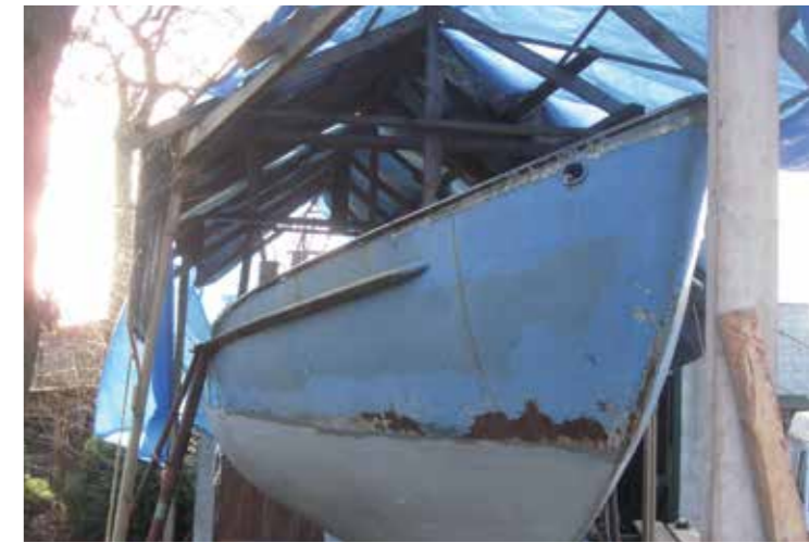
HET ONDERWATERSCHIP WERD ONTROEST EN BEHANDELD
