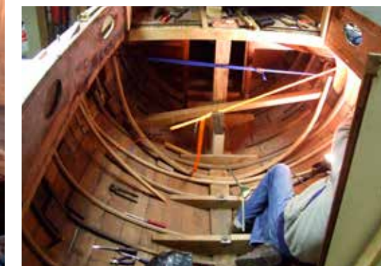
WRANGEN, SPANTEN EN EEN AANTAL GANGEN WORDEN VERVANGEN
