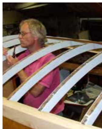
NIEUWE BALKEN VOOR HET KAJUITDAK WORDEN GEMAAKT
